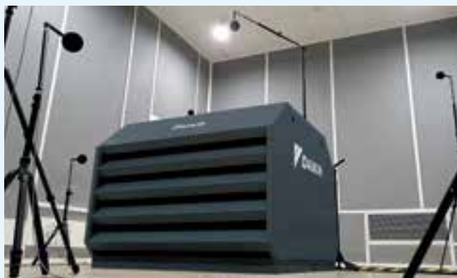
Messung der Schallleistungspegel in einer Akustikkammer
