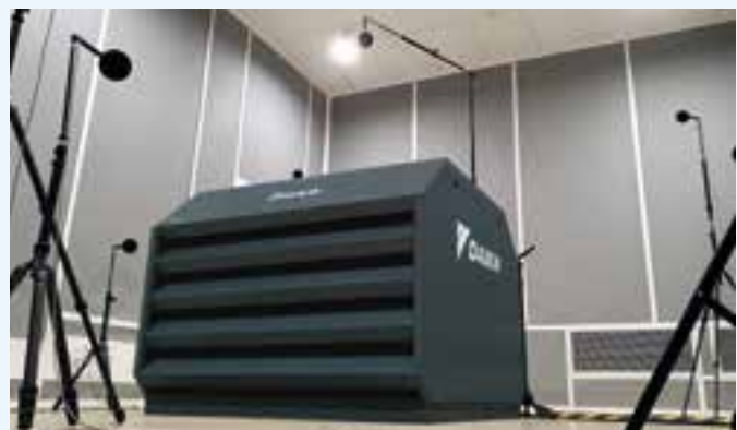
Messung der Schallleistungspegel in einer Akustikkammer
